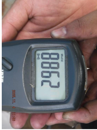
รูปที่ 42 ความเร็วรอบของมอเตอร์ (Motor Speed) ที่อ่านค่าได้ เท่ากับ 2,988 รอบต่อนาที (rpm.)
