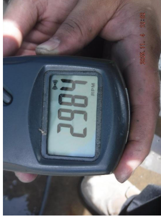
รูปที่ 62 ความเร็วรอบของมอเตอร์ (Motor Speed) ที่อ่านค่าได้ เท่ากับ 2,984 รอบต่อนาที (rpm.)
