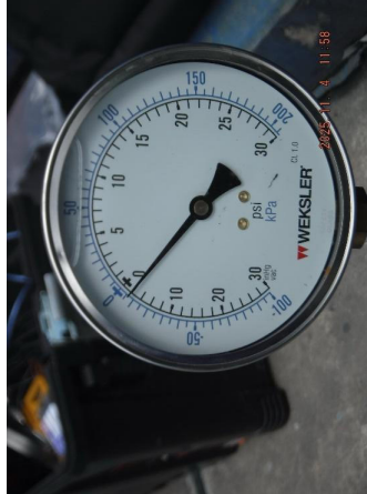
รูปที่ 53 Suction Pressure ที่อ่านค่าได้เท่ากับ -2 in.Hg.
