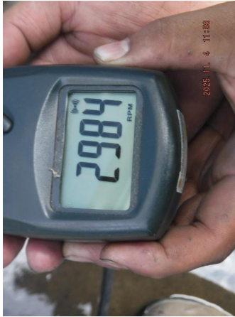
รูปที่ 52 ความเร็วรอบของมอเตอร์ (Motor Speed) ที่อ่านค่าได้ เท่ากับ 2,984 รอบต่อนาที (rpm.)
