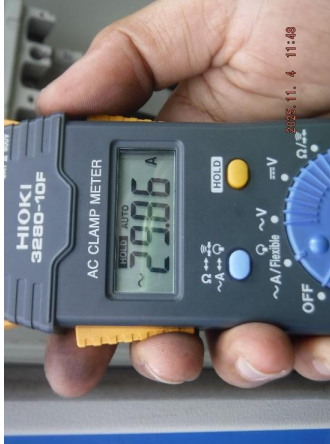
รูปที่ 17 กระแสมอเตอร์เฟส S ที่อ่านค่าได้เท่ากับ 29.86 Amp.
