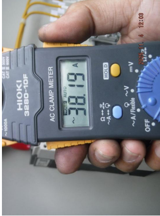
รูปที่ 67 กระแสมอเตอร์เฟส S ที่อ่านค่าได้เท่ากับ 38.19 Amp.
