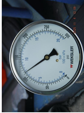
รูปที่ 44 Discharge Pressure ที่อ่านค่าได้เท่ากับ 112 psi.
