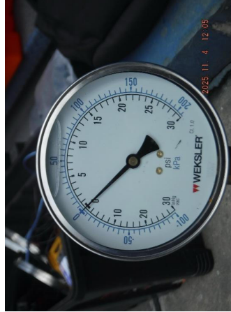
รูปที่ 43 Suction Pressure ที่อ่านค่าได้เท่ากับ 0 inHg.
