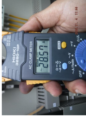
รูปที่ 7 กระแสมอเตอร์เฟส S. ที่อ่านค่าได้เท่ากับ 28.57 Amp.
