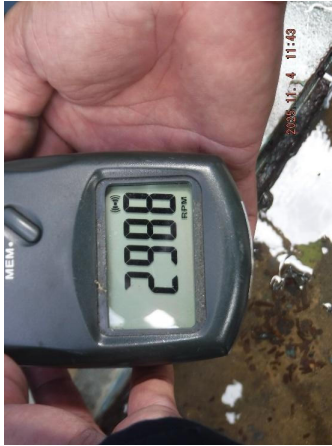
รูปที่ 2 ความเร็วรอบมอเตอร์ (Motor Speed) ที่อ่านค่าได้ เท่ากับ 2,988 รอบต่อนาที (rpm.)
