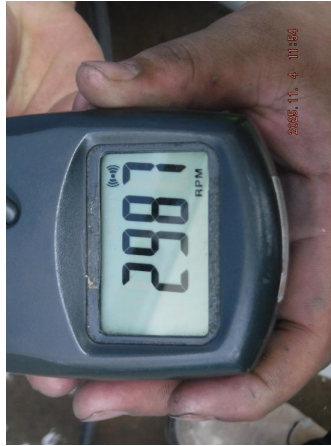
รูปที่ 32 ความเร็วรอบของมอเตอร์ (Motor Speed) ที่อ่านค่าได้เท่ากับ 2,987 รอบต่อนาที (rpm.)
