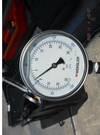
รูปที่ 33 Suction Pressure ที่อ่านค่าได้เท่ากับ 1.2 psi.
