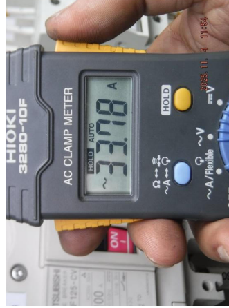
รูปที่ 39 กระแสมอเตอร์เฟส T ที่อ่านค่าได้เท่ากับ 33.78 Amp.
