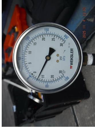
รูปที่ 63 Suction Pressure ที่อ่านค่าได้เท่ากับ -6 in.Hg.
