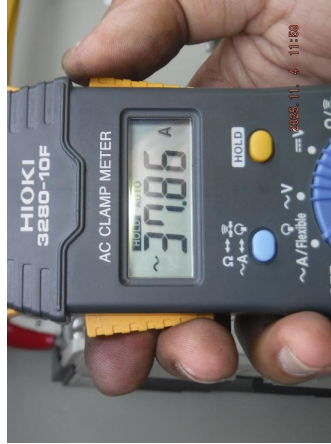
รูปที่ 59 กระแสมอเตอร์เฟส T ที่อ่านค่าได้เท่ากับ 37.86 Amp.
