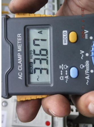
รูปที่ 47 กระแสมอเตอร์เฟส S ที่อ่านค่าได้เท่ากับ 33.67 Amp.
