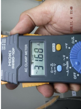
รูปที่ 19 กระแสมอเตอร์เฟส T ที่อ่านค่าได้เท่ากับ 31.68 Amp.
