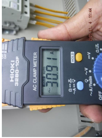
รูปที่ 5 กระแสมอเตอร์เฟส R. ที่อ่านค่าได้เท่ากับ 30.91 Amp.
