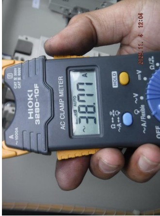
รูปที่ 69 กระแสมอเตอร์เฟส T ที่อ่านค่าได้เท่ากับ 38.77 Amp.
