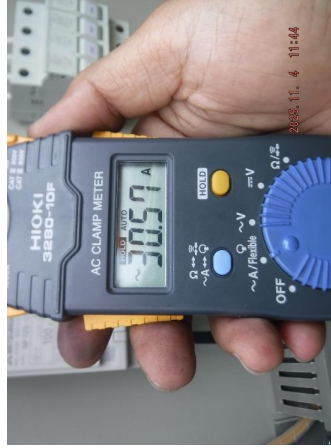
รูปที่ 9 กระแสมอเตอร์เฟส T. ที่อ่านค่าได้เท่ากับ 30.57 Amp.
