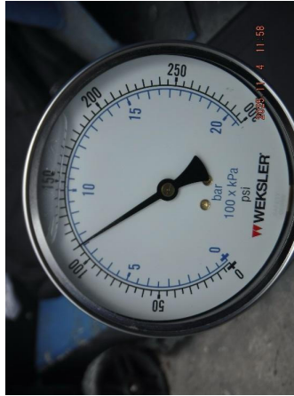
รูปที่ 54 Discharge Pressure ที่อ่านค่าได้เท่ากับ 110 psi.
