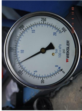
รูปที่ 14 Discharge Pressure ที่อ่านค่าได้เท่ากับ 119 psi.
