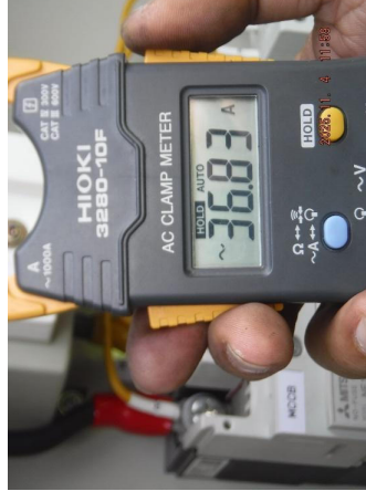
รูปที่ 57 กระแสมอเตอร์เฟส S ที่อ่านค่าได้เท่ากับ 36.83 Amp.
