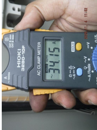
รูปที่ 25 กระแสมอเตอร์เฟส R. ที่อ่านค่าได้เท่ากับ 34.15 Amp.
