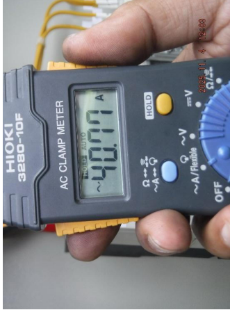
รูปที่ 65 กระแสมอเตอร์เฟส R ที่อ่านค่าได้เท่ากับ 40.77 Amp.
