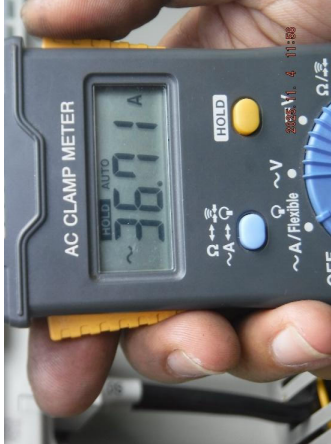
รูปที่ 45 กระแสมอเตอร์เฟส R ที่อ่านค่าได้เท่ากับ 36.71 Amp.
