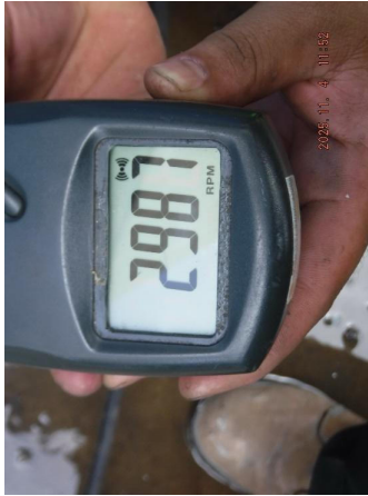
รูปที่ 22 ความเร็วรอบของมอเตอร์ (Motor Speed) ที่อ่านค่าได้ เท่ากับ 2,987 รอบต่อนาที (rpm.)
